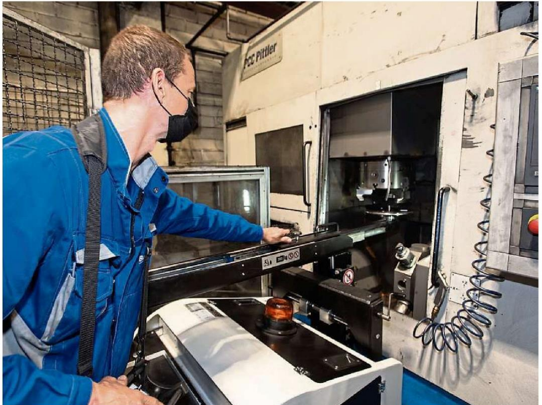
Roland Taba führt vor, wie er mit dem neuen Kran ein Spannfutter wechselt. Bislang musste er aufwendig in der Öffnung hantieren – diese anstrengende Arbeit übernimmt jetzt die Maschine. Foto: Mark Adel
