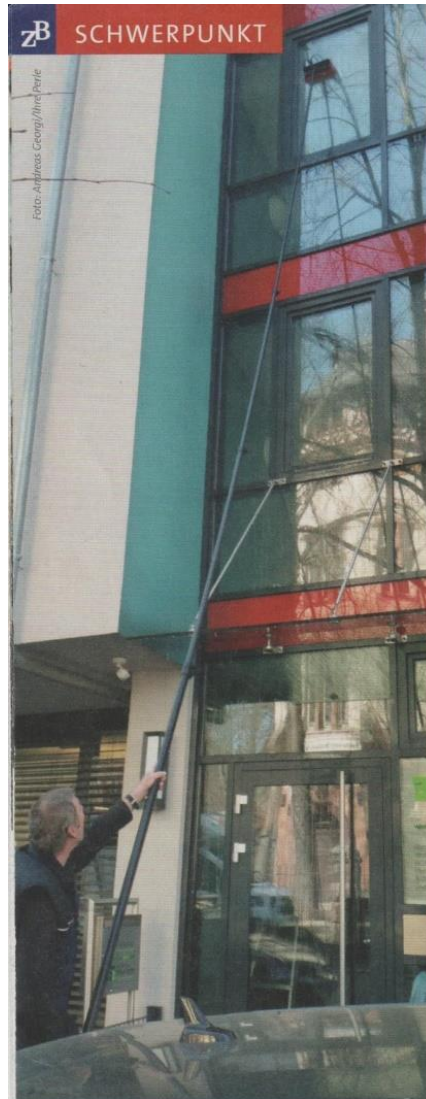
Ein Teleskop-Fensterputzgerät erspart Norbert Harnack das Arbeiten in luftiger Höhe
